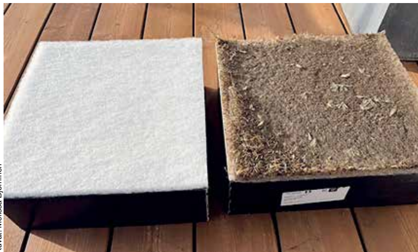
Puhdas ja likainen PILP-suodatin kesäaikana rinnakkain. Vaihtoväli on ollut n. 2 kk.
