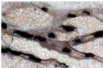
Hevosmuurahainen ja tuhon jäljet eristelevyssä.
