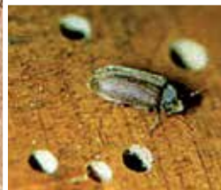
Tupajumin lentoreikiä rakenteessa.
